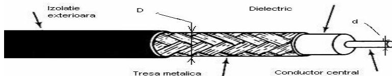
In practica firul interior este inconjurat de un izolator tubular flexibil cu o inalta constanta dielectrica Toate fiind inconjurate de un strat conductor(de obicei,din sarma fin tesuta pentru flexibilitate,sau de o folie subtire metalic),si in final acoperita cu un strat subtire de izolatie exterior.
