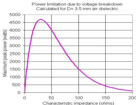
Sistemele CATV au fost una dintre primele aplicatii pentru mari cantitati de cablu si foloseste un nivel scazut de putere RF. O medie aritmetica intre 30 ohmi si 77 ohmi da 53,5 ,s-a ales 50 Ohmi ca un compromis intre putere si capacitatea de atenuare.
